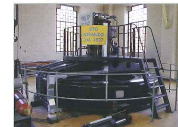
Sotto. Ininterrottamente attiva dal 1927, questa turbina non ha mai subito nel tempo interventi di ristrutturazione.
